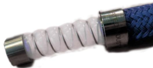
Tubo flessibile con sottostrato in PTFE convoluto estruso e sinterizzato senza giunzioni, rivestito con una treccia metallica in AISI 304, resistente alla corrosione ed alle vibrazioni, con un'elevata flessibilità e bassa permeabilità.
